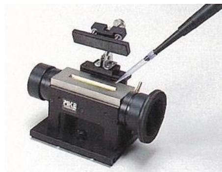
Fig.1 水平形ATR装置
